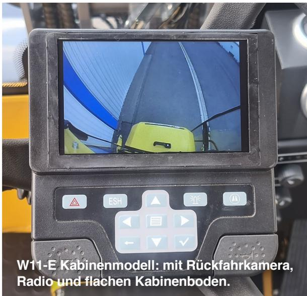
W11-E Kabinenmodell: mit Rückfahrkamera, Radio und flachen Kabinenboden.
